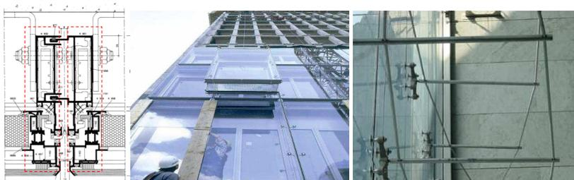
Fig. 1 - facciata continua a montanti e traversi; Fig. 2 - facciata continua strutturale; Fig. 3 - facciata continua a cellule; Fig. 4 - facciata continua appesa o a fissaggio puntuale
