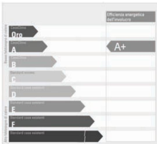
Certificato CasaClima: fabbisogno annuale di energia termica per riscaldamento  $< 30 \text{ kWh/m}^2\text{a}$ ; nessun materiale chimico usato per l'isolamento termico.
