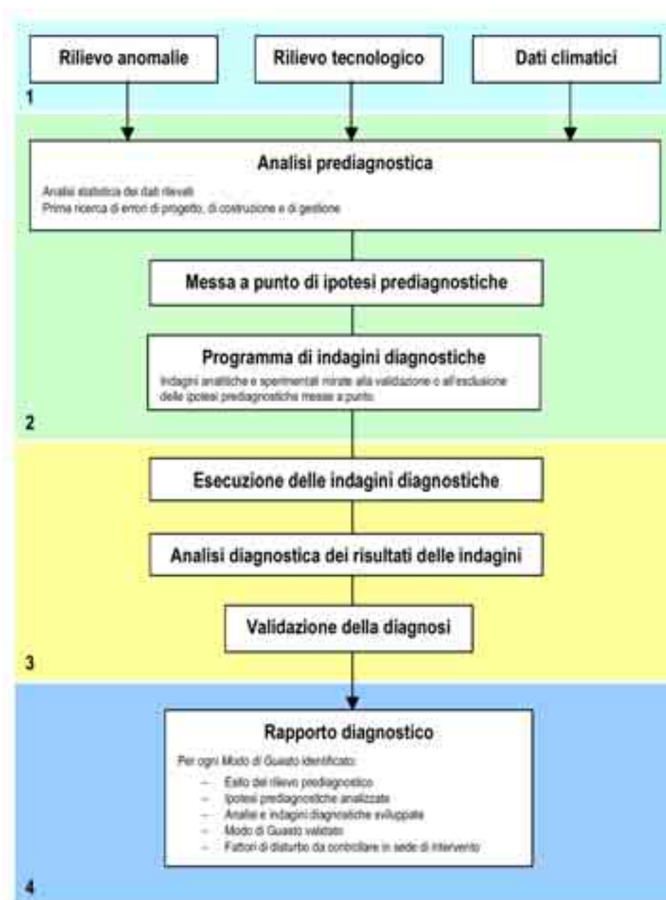
Figura 2. Le fasi del “processo diagnostico”: 1) rilievo preliminare; 2) prediagnosi; 3) diagnosi; 4) formalizzazione della diagnosi.
